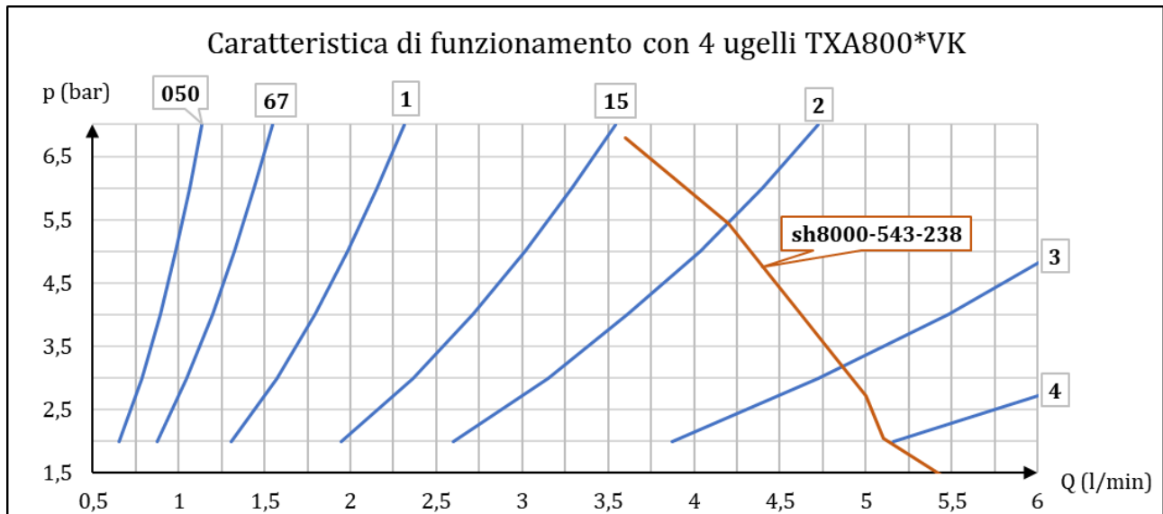
Fig. 27. Diagramma caratteristico del circuito di irrorazione progettato con un parallelo di quattro ugelli irroratori TXA. Per brevità, le curve di possibili circuiti configurati con taglie diverse sono identificate solo dal numero del modello, corrispondente all'asterisco nel nome completo dell'ugello (titolo grafico); la pompa è indicata per esteso
