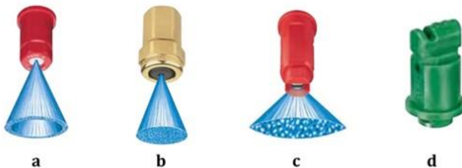
Fig. 24. Ugelli: a) cono vuoto, b) cono pieno (a piastrine), c) ventaglio, d) specchio
