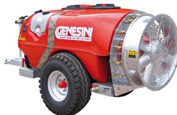
Fig. 19. Atomizzatore convenzionale Genesini Sirio. La versione più piccola ha una massa di 520 kg a vuoto, può trasportare 880 l di miscela, è lungo circa 2,5 m e la ventola da 80 cm può generare fino a 60 000 m 3 /h di flusso d'aria
